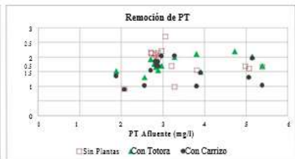
Figura 4. Concentraciones de PT de entrada y salida para los HSSF
